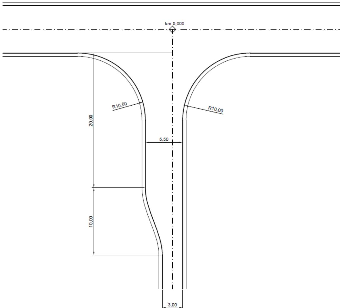
Anmerkung: Bei dem Ausbau von Wegen mit einer Fahrbahnbreite von 3,5 m wird der Übergangsbereich auf diese Breite ausgerichtet.
