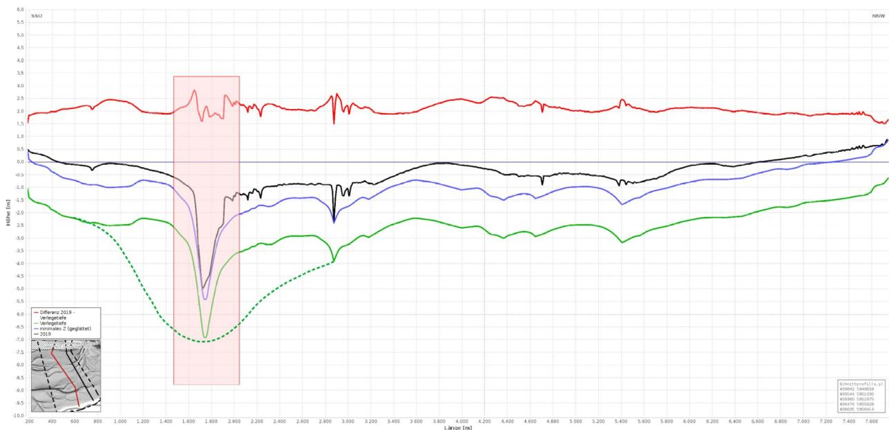
Abbildung 46: Mögliche Anpassung (gestrichelte dunkelgrüne Linie) der Verlegetiefe im Bereich tiefer, steiler Rinnen am Beispiel der Kreuzung der Trasse C6a mit dem Neuharlingersieler Wattfahrwasser
